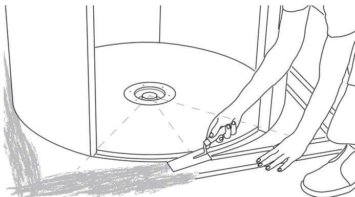
**13)** I giunti di collegamento dell'elemento del pavimento al massetto o alla parete sono sigillati con il set di sigillante bi-componente (o equivalente) JACKOBOARD®.
