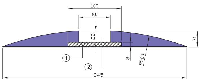
1) Piastra di rinforzo sulla parte anteriore per il fissaggio dell'asta della doccia e del soffione
