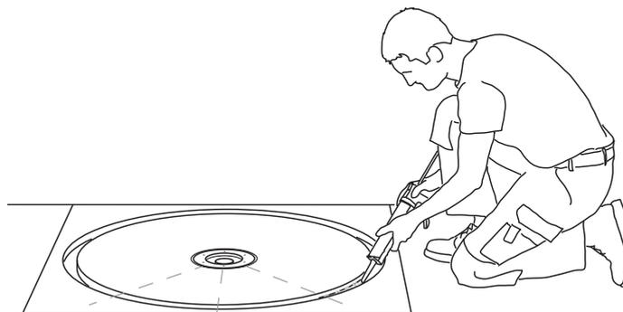
**2)** Per fissare il primo elemento a parete, il collante e sigillante BOARD-FIX® viene applicato sulla scanalatura fresata.
