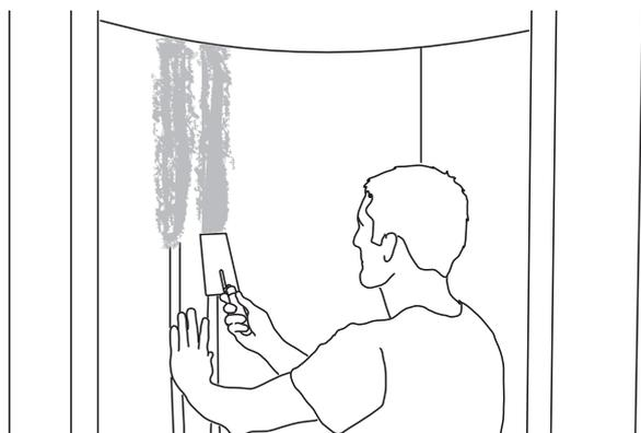
**11)** Tutti i giunti longitudinali degli elementi della parete vengono riempiti all'interno con il nastro di armatura JACKOBOARD® utilizzando il collante per piastrelle. Gli spigoli frontali nella zona d'ingresso e i giunti longitudinali sul lato esterno vengono spatolati via con il nastro di armatura JACKOBOARD®.
