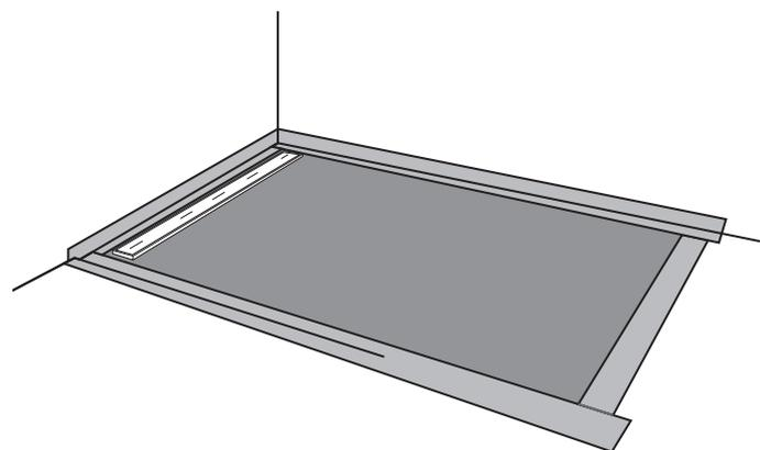
**10)** Il montaggio di Aqua Line easy JACKOBOARD® è ultimato e l'elemento doccia può essere piastrellato. La guida d'inserimento in acciaio inox è piastrellabile sul retro. Per fare ciò girarla semplicemente e piastrellare.
