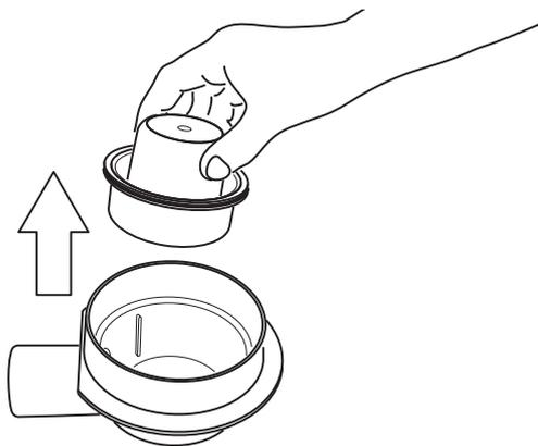
**1)** Se lo scarico a pavimento include un sifone anti-odori, rimuovere interamente questo pezzo (parte superiore e inferiore). Lo scarico della doccia è già provvisto di uno speciale sifone anti-odori.
