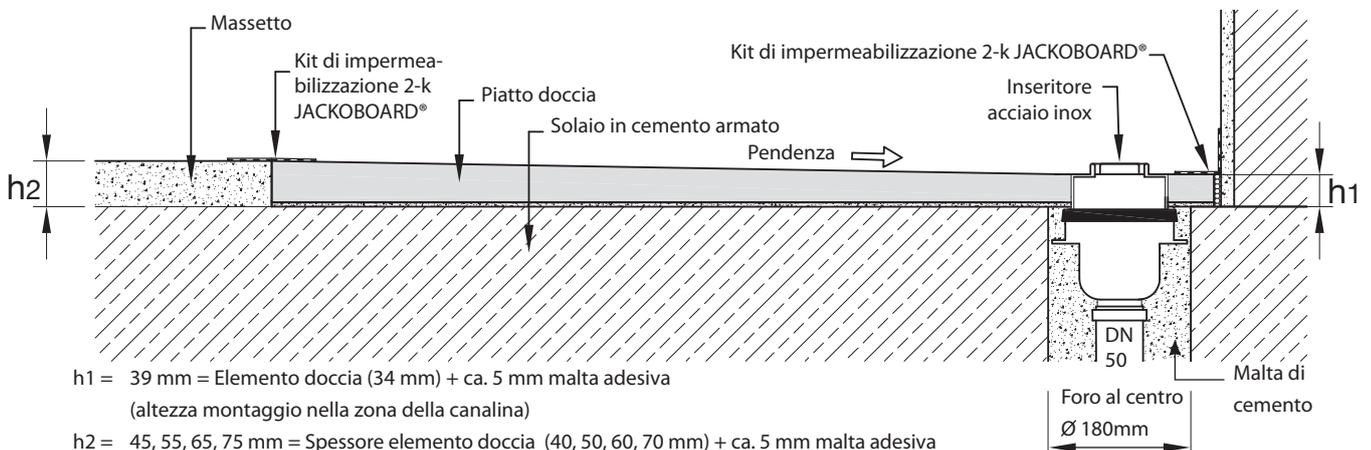
$h_1 = 39 \text{ mm} = \text{Elemento doccia (34 mm)} + \text{ca. 5 mm malta adesiva}$
