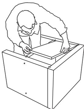
**7)** Premere la piastra di montaggio nello scomparto superiore del lavabo. Questa assicura l'ortogonalità del lavabo e una volta che la colla si è indurita viene rimossa.
