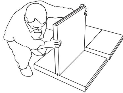
**2)** Inserire il ripiano intermedio nelle scanalature della parete laterale. Verificare la complanarità fra ripiano intermedio e parete laterale.
