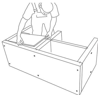
9) Le piastre di montaggio vengono premute negli scomparti superiori del lavabo. Queste assicurano l'ortogonalità del lavabo e una volta che la colla si è indurita vengono rimosse.
