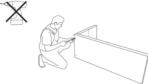
**3)** Il piano viene avvitato alla parete laterale. Per fare questo le viti vengono posizionate sui fori di invito utilizzando le rondelle. Le viti vanno inserite con un giravite a mano fino a che la loro testa non si trova a livello della superficie.
