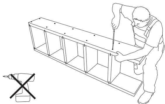
**6)** Le due pareti laterali dello scaffale vengono avvitate fra loro inserendo le viti fornite in dotazione nei fori di invito e utilizzando le rondelle. A tale proposito le viti vanno inserite con un giravite a mano fino a che la loro testa non si trova a livello della superficie.
