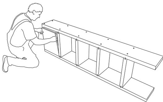
**7)** Premere la piastra di montaggio nello scomparto superiore dello scaffale. Questa assicura l'ortogonalità dello scaffale e una volta che la colla si è indurita viene rimossa.
